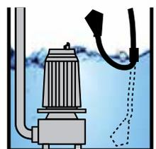
Fijación con lastre ajustable sobre el cable Opcional para estos aparatos
